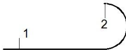
Şək. 21. Obyektin Polyline komandası ilə çəkilməsi
